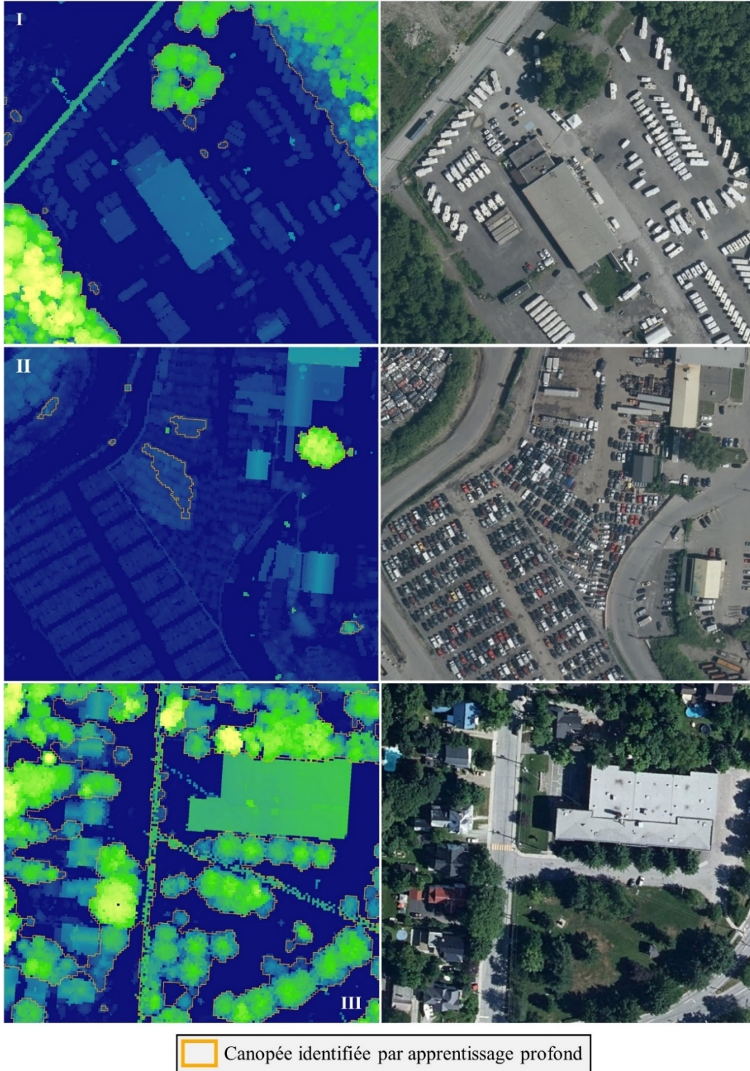
Figure 37. Illustration avec le modèle numérique de hauteur et l'image aérienne d'erreurs de commission relevées (I. Véhicules récréatifs, II. Groupement de véhicules, III. Câbles électriques).
